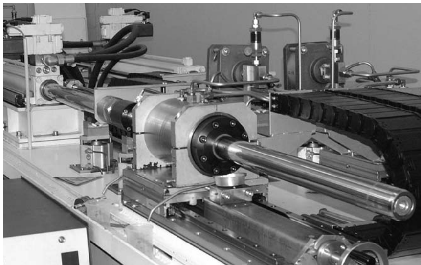
Dauerlaufprüfstand für Hydraulik-Stangendichtungen Endurance test rig for hydraulic rod seals
